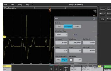
内置可选 16 通道 MSO，50MHz AFG，4 位码型发生器和 DVM/ 计数器功能，是测试数字电路或激励被测回路的最佳选择。
