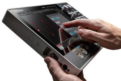
10.1 英寸彩色触摸屏，操作直观。简化用户界面使您快速调用任何功能。
