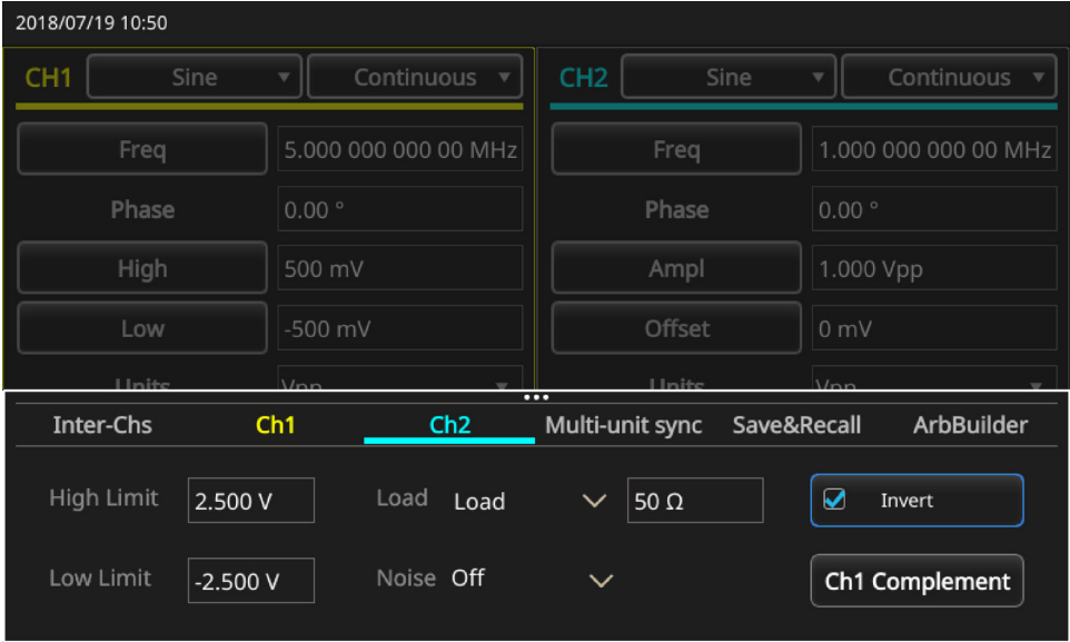
图 46：反转通道 1 和通道 2 波极性
