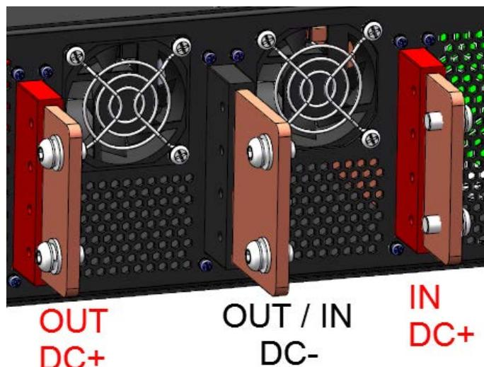
注意: 后面板的 IN、OUT 的正负电极最大电流为 1000A。
