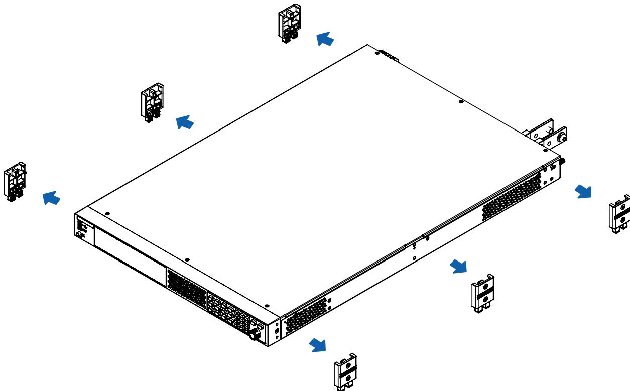
卸除侧底脚后仪器。用户可以在仪器两侧看到连接件安装孔。
