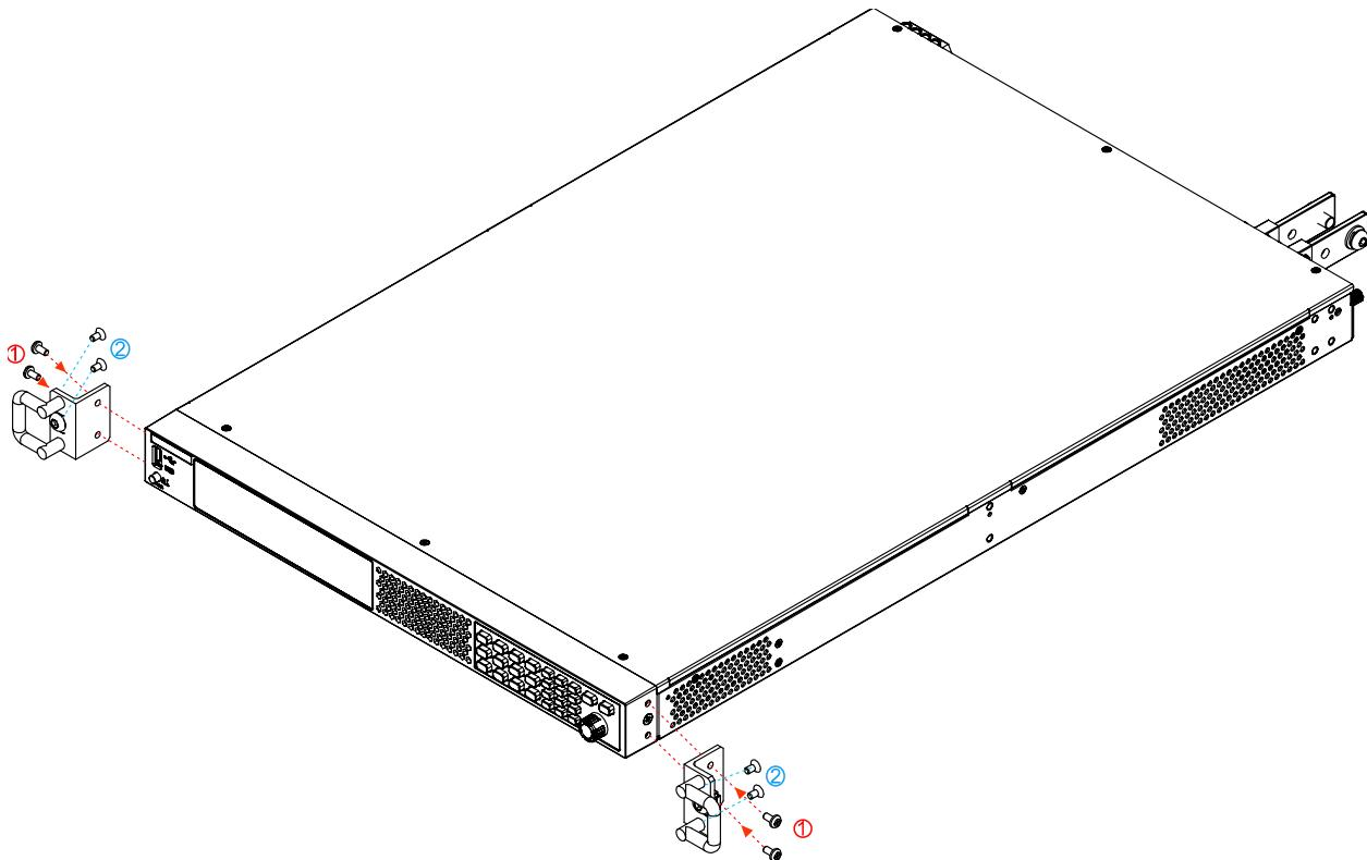
2. 根据下图所示步骤，安装后端 IT-E155B 连接件或 IT-E155C 连接件或 IT-E155D 连接件，IT-E155C 除了两侧的固定连接件不相同外，其他组件安装方式相同。
