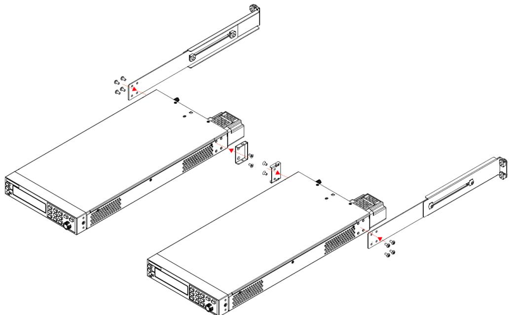
3. 根据下图所示步骤，将两台安装好左右支架配件的仪器并到一起，再用螺丝上下固定好两台仪器的前端和后端。
