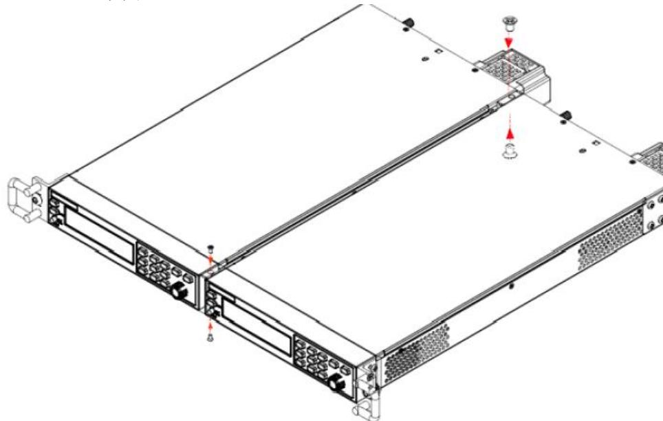
4. 用户可以将完成支架安装后的两台仪器安装到标准的机柜上。
