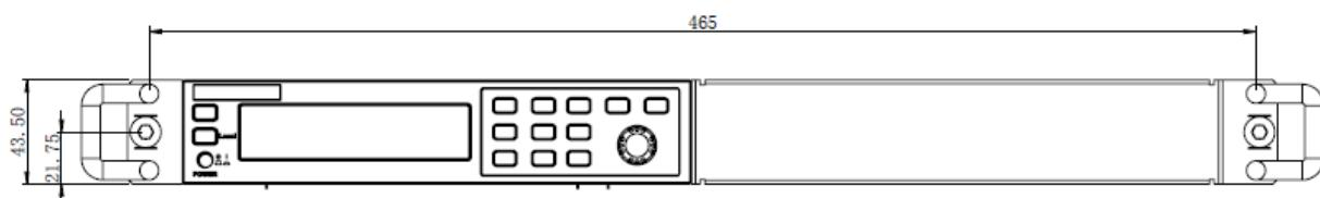
IT-E154C 后端的支架是可伸缩式的，用户可以根据机柜需要进行伸缩调节，最长可达 869.50mm，最短可到 734.50mm。
