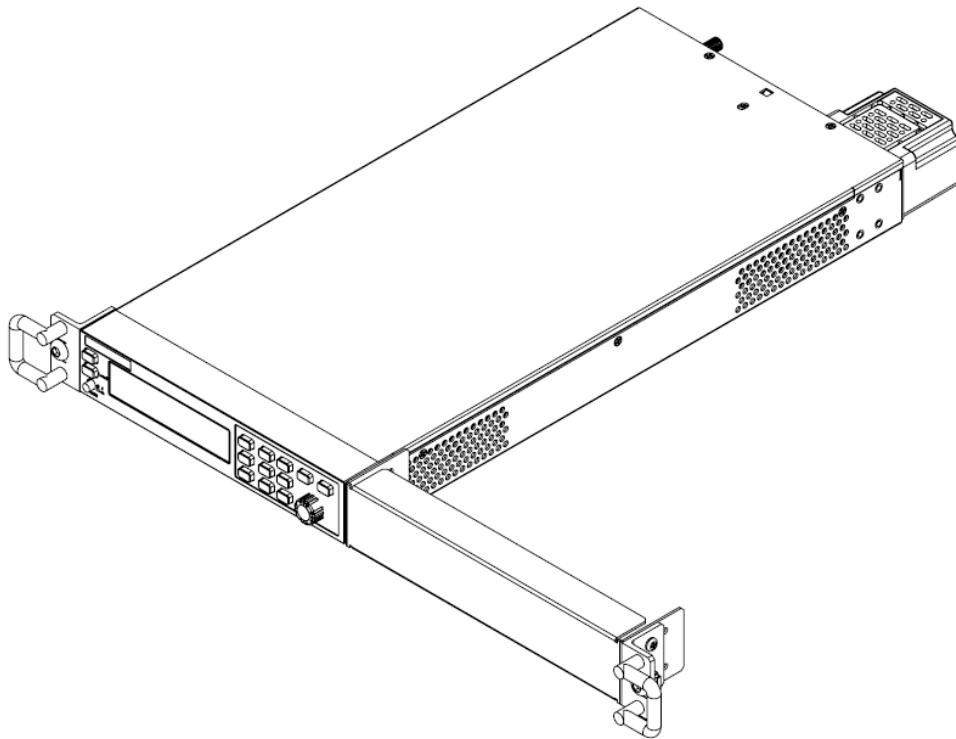
2. 根据下图所示步骤，安装后端支架 IT-E154C。
