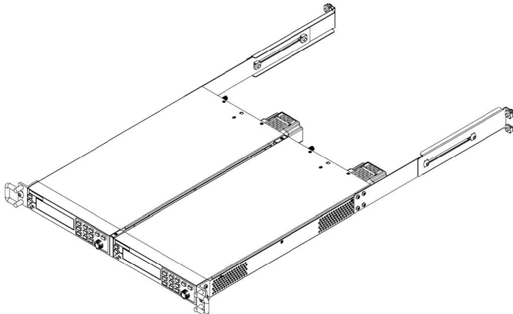
5. 用户可以将完成支架安装后的仪器安装到标准的机柜上，安装支架后仪器尺寸如下图所示。（单位：毫米）
