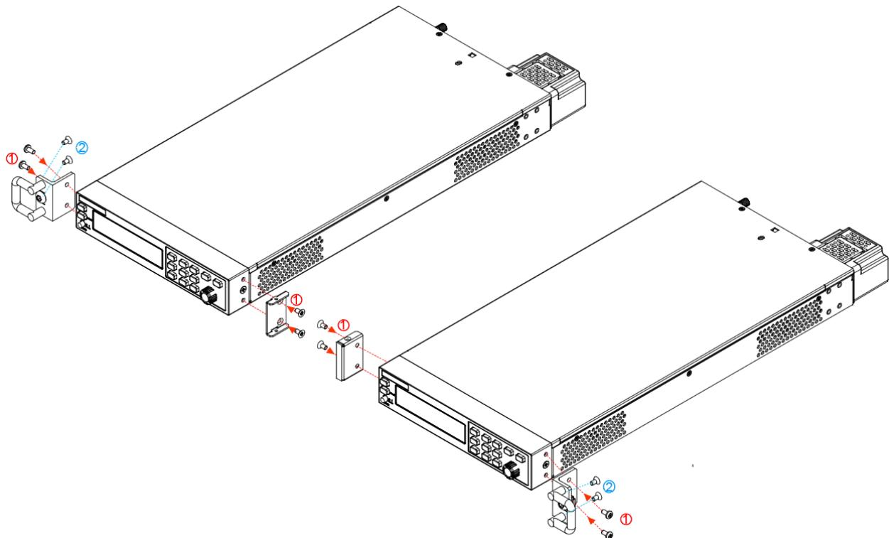
3. 根据下图所示，将两台安装好左右耳的仪器并到一起，再用螺丝上下固定好两台仪器。
