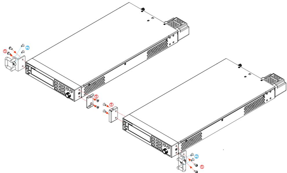
2. 根据下图所示步骤，安装后端支架 IT-E154C 配件。
