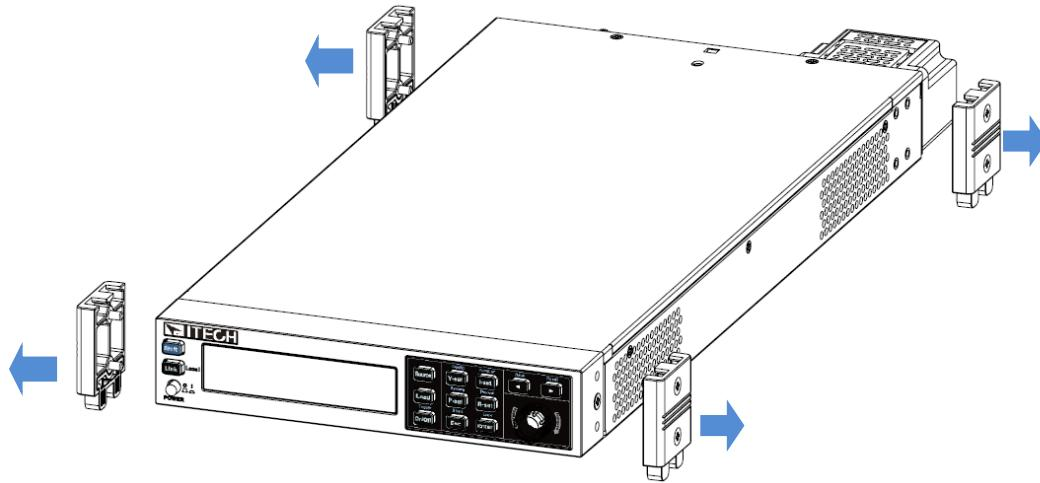
卸除侧底脚后仪器。用户可以在仪器两侧看到支架安装孔。
