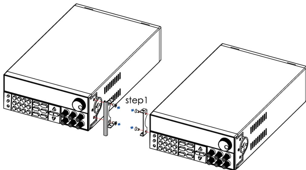
2. 安装完成后，将两台仪器并到一起，用螺丝将步骤一安装的配件连接好。如下图所示。
