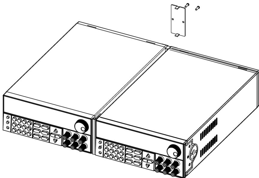
4. 两台仪器并机完成，再将 IT-E151A 支架左右耳安装到两台仪器左右两侧。
