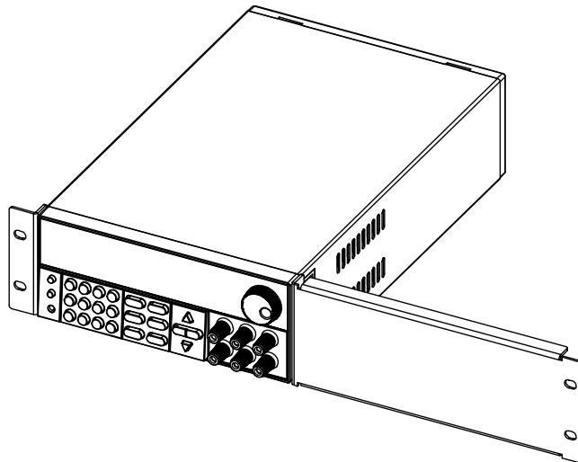
3. 用户可以将完成支架安装后的仪器安装到标准的机柜上，安装支架后仪器尺寸如下图所示。（单位：毫米）
