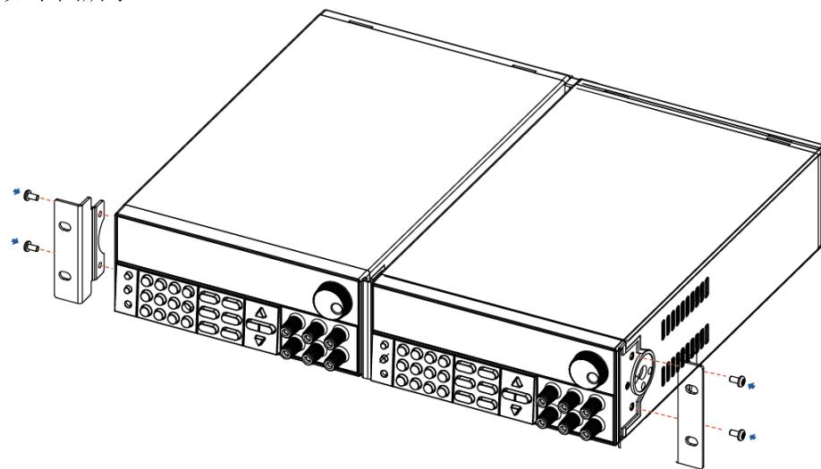
5. 用户可以将完成支架安装后的两台仪器安装到标准的机柜上，安装支架后仪器尺寸如下图所示。（单位：毫米）
