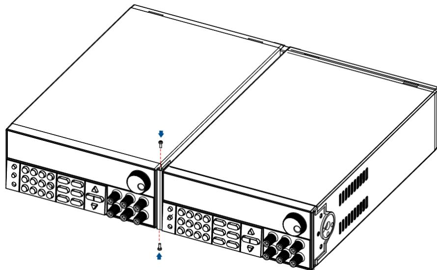
3. 将后面板固定件安装完成，如下图所示。
