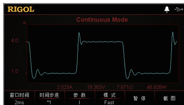
负载提供波形显示功能，并支持对波形进行暂停、记录和截图等操作，方便用户通过动态波形来观察参数的变化趋势。
