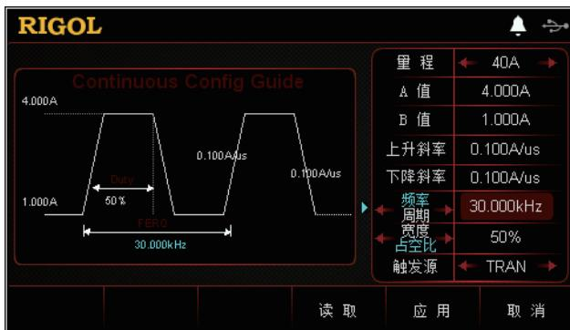
动态测试功能能够使负载根据设定的规则在两种设定参数间(A值和B值)进行切换，此功能可以用来测试被测设备的动态特性，其中频率最高可设置为30 kHz。此外，在向导界面中，用户可以在参数配置列表中设置相关参数，并通过参数配置向导直观的进行查看。
