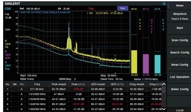
具备 EMI 滤波器和准峰值检波器的 EMI 测量模式，预存标准限制线集合
