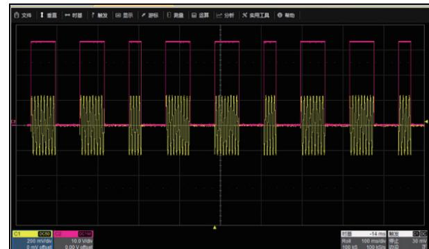
使用 ARB 模式，采样率高达 1.25 GHz，结合上位机 SigIQPro 产生常用的通信协议信号如 5G NR, LTE, WLAN 等多种协议信号
