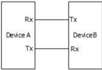
图 3.2 RS232 串行总线示意图
