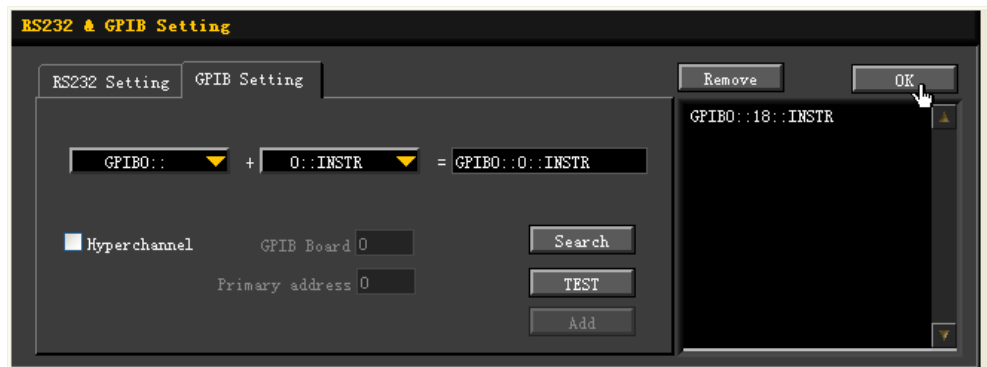
图 2.2 确认 GPIB 连接设备
