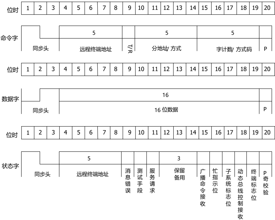
图 3.15 1553B 总线命令字、数据字和状态字格式图
