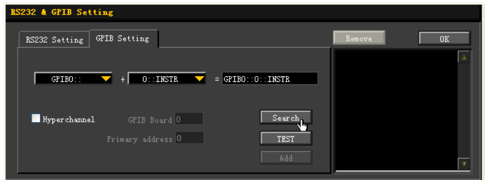
图 2.1 搜索 GPIB 连接设备
