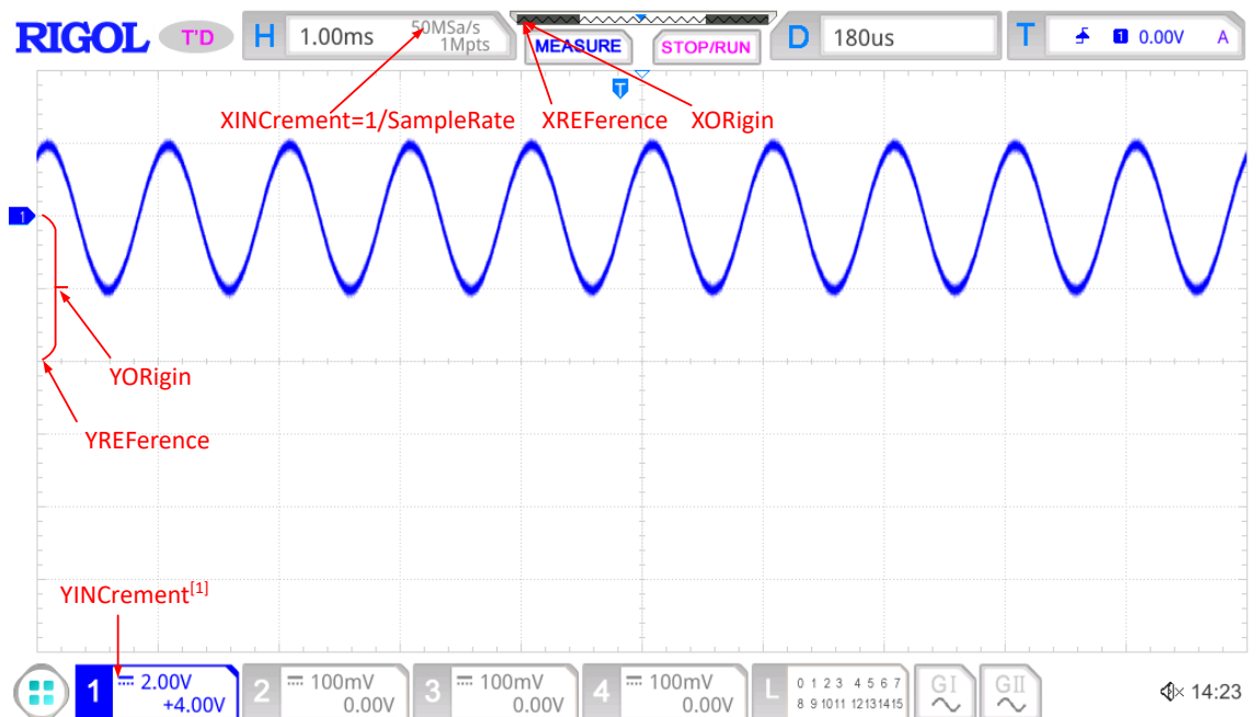
图 3.17 RAW 模式下的参数定义
