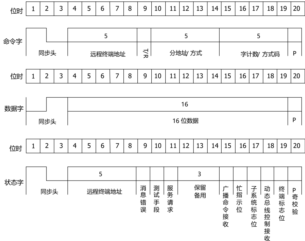
图 8.24 1553B 总线命令字、数据字和状态字格式图
