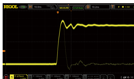
高刷新率模式下捕获偶发异常信号
