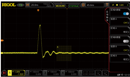
通过边沿触发+ 区域触发，简单快速地分离异常信号
