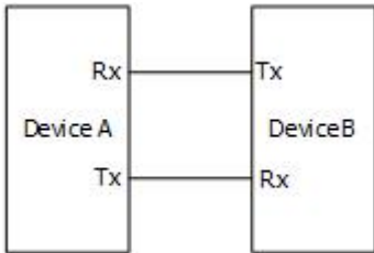
图 17.4 UART/RS232 串行总线示意图
