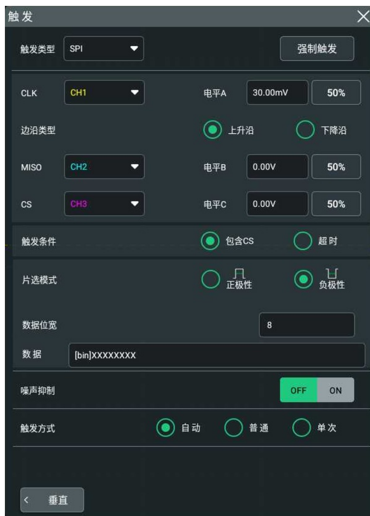
图 8.33 SPI 触发配置菜单
