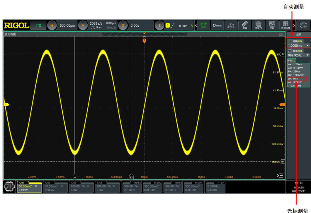
图 10.11 手动光标测量实例
