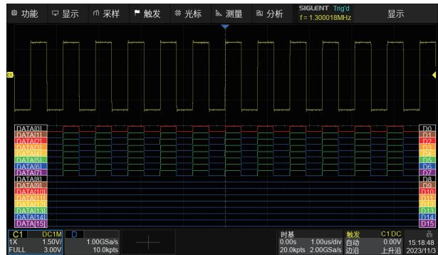
搭配 16 路逻辑分析仪探头选件 (SLA1016)，为仪器增加 16 路数字通道，同时不影响其他测试功能，实现混合信号的采集与分析，快速解决模数混合信号设计与分析等问题
