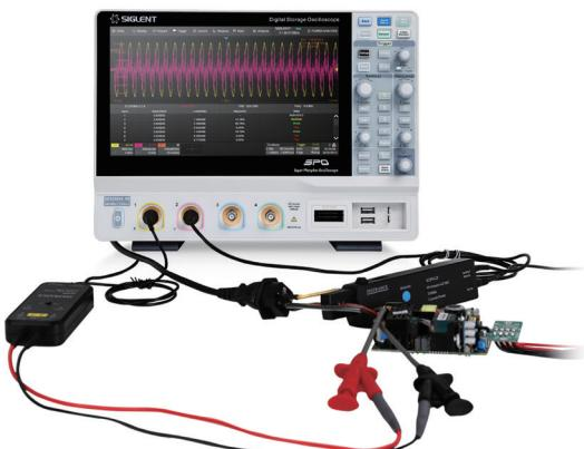
电源分析选件能帮助用户快捷测量和分析电力电子领域中的多个项目，如电源质量，谐波，浪涌电流，开关损耗，输出纹波，瞬变响应，电源抑制比，功率效率等
