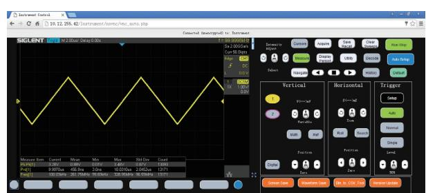
内嵌 Web Server，无需安装驱动软件和上位机软件，通过浏览器即可对仪器进行远程控制、观察波形、获取测量结果，可满足高压、高温等特殊环境的应用需求。内嵌的虚拟控制面板和示波器面板完全相同，使用起来更加简单方便。SDS2000X-E 支持 PC 和手机两种风格的网页布局，在手机上也能轻松完成控制和观察。
