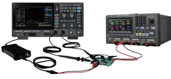
搭配隔离信号发生器选件 (SAG1021I) 或 SDG 任意波形发生器即可进行环路响应测试，提供被测设备 (DUT) 的频率响应曲线，轻松获得各个频率点下的增益和相位值
