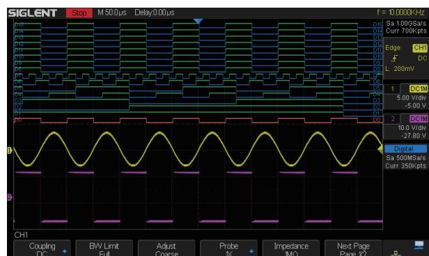
通过外接 16 路逻辑分析仪模块（SLA1016），SDS1000X-E 支持 MSO 功能，最高采样率高达 1 GSa/s
