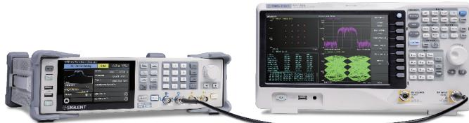
可生成常用的 ASK, FSK, PSK, QAM 等调制类型的 IQ 信号。采用创新的重采样技术，可以在 250 Symb/s ~ 500 MSymb/s 范围内的任意符号率下获得优异的 EVM 性能。内建的数字正交调制器可将 IQ 信号的载波调制到 1 GHz 范围内的任意频点；可使用上位机软件 EasyIQ 来生成各种类型的 IQ 信号
