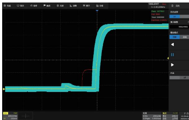
基于硬件的模板测试功能，最高每秒可执行 25 000 次测试。根据用户自定义的垂直和水平容限生成模板，比较被测信号是否触碰模板，如果被测信号触碰模板则测试失败，可以预先设定测试失败时采集停止以及蜂鸣器告警，将失败帧自动截图或存入历史帧，适用于长期无人值守监测异常信号
