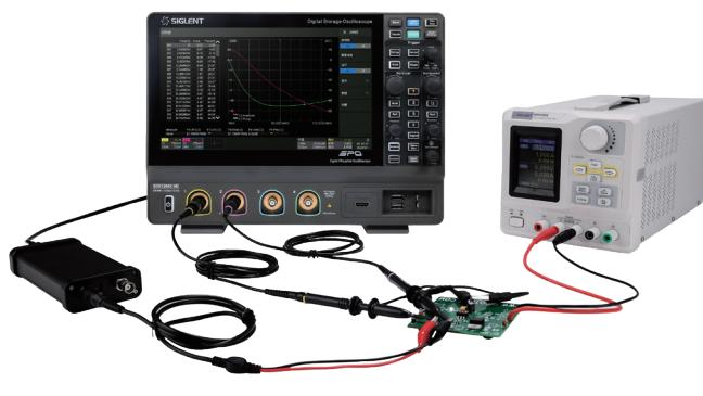
利用波特图测试系统的频率响应或环路稳定性，在一定领域取代昂贵的网络分析仪。可搭配波形发生器选件或SDG系列任意波形发生器
