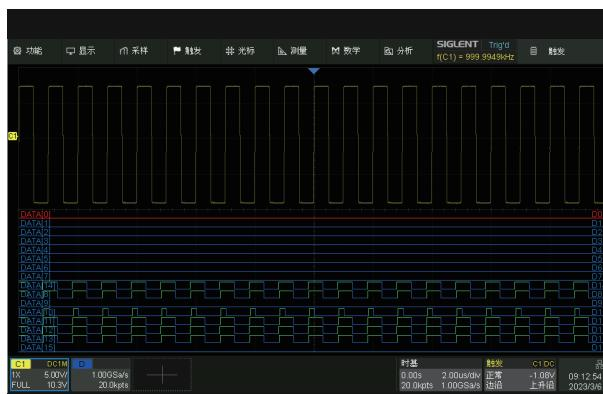
使用16路逻辑分析仪探头SLA1016，可实现16路数字通道采集功能。数字通道与模拟通道结合，以实现混合信号采集与分析功能
