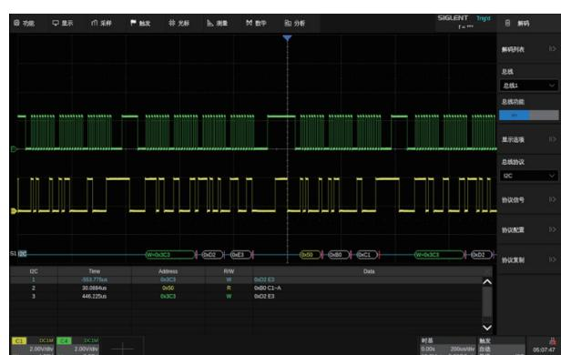
通过事件列表显示解码，能快速、直观地将总线的协议信息以表格形式显示。支持 I2C、SPI、UART、CAN、LIN、CAN FD、FlexRay、I2S、MIL-STD-1553B、SENT 和 Manchester 等多种协议
