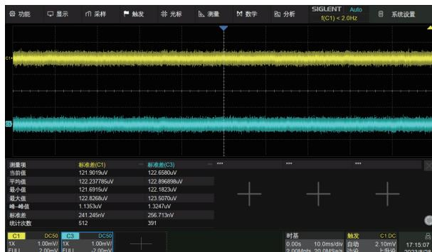
优秀的本底噪声性能，在1 GHz全带宽下的底噪值仅为125  $\mu$ Vrms，让12-bit ADC充分发挥性能
