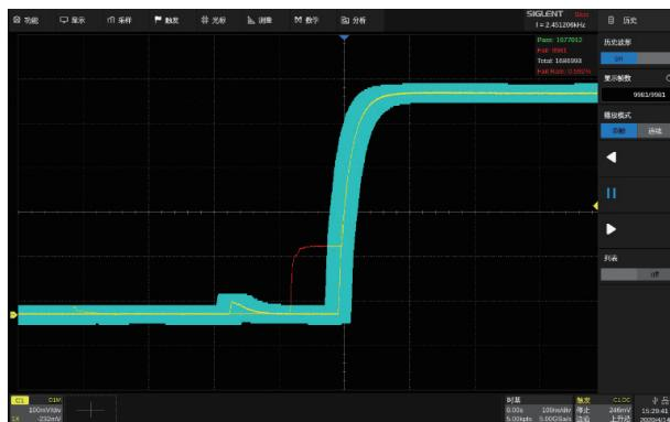
基于硬件的模板测试功能，最高每秒可执行 25 000 次测试。根据用户自定义的垂直和水平容限生成模板，比较被测信号是否触碰模板，如果被测信号触碰模板则测试失败，可以预先设定测试失败时采集停止以及蜂鸣器报警，将失败帧自动截图或存入历史帧，适用于长期无人值守监测异常信号
