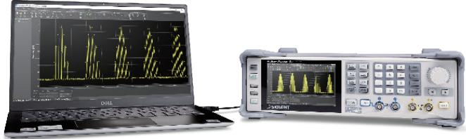
分段编辑和播放：提供把最高 1024 段任意波无缝拼接的能力，每段波形可单独设置重复次数，最高次数 65535 次。这种模式在切换任意波时直接从前一段的最后一个点跳转到后一段的第一个点，不会产生空闲电平，适用于对波形切换要求很高的场合
