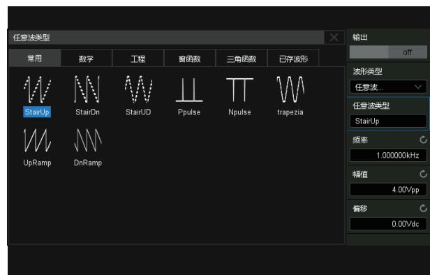
通过USB Host接入25MHz USB任意波形发生器模块，集成正弦波、方波、三角波、脉冲波、噪声、直流以及45种内建任意波，用户也可通过EasyWave上位机软件编辑任意波形。
