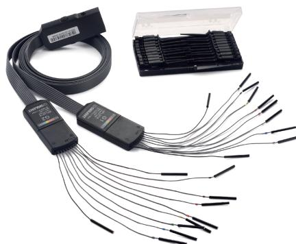
使用 16 路逻辑分析仪探头 SPL2016, 可实现 16 路数字通道采集功能。数字通道与模拟通道结合，以实现混合信号采集与分析功能
