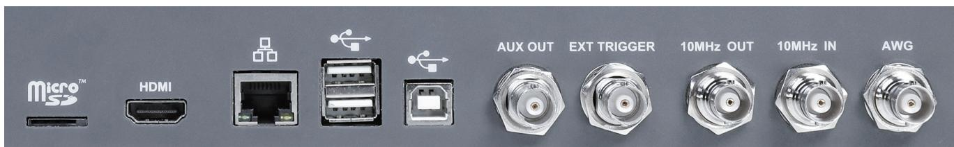
提供 1 个 HDMI 视频输出接口、2 个 USB Host 3.0 和 2 个 USB Host 2.0、1 个 USB Device 2.0 (USBTMC)、1 个 1000M LAN (VXI-11/Telnet/Socket)、1 个 micro SD 卡、1 个辅助输出 (Pass/Fail 和 Trigger Out 复用)、1 个 10 MHz In 和 1 个 10 MHz Out。
