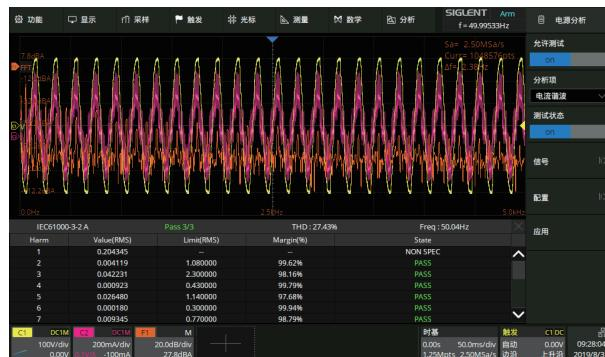
电源分析选件能帮助用户快捷测量和分析电力电子领域中的多个项目，如电源质量，谐波，浪涌电流，开关损耗，输出纹波，瞬变响应，电源抑制比，功率效率等
